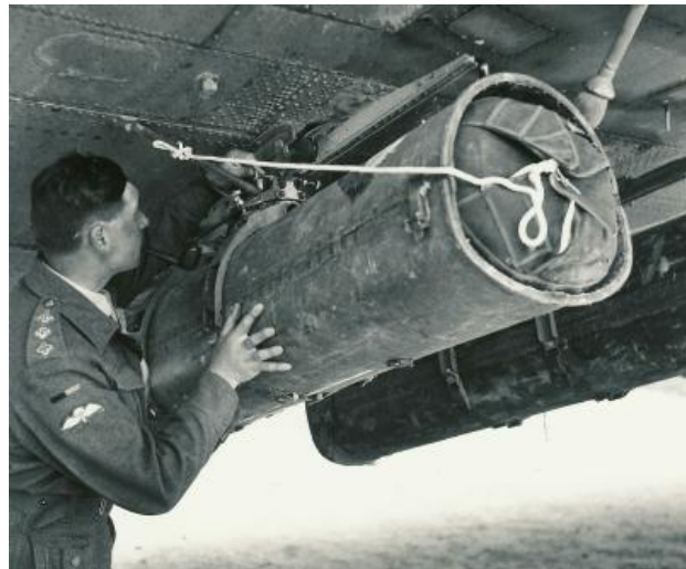
Fig. 5.37 (rechts) dropcontainers onder een Dakota. De bevestiging is duidelijk zichtbaar.
