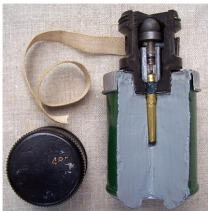
Fig. 5.17 Doorsnede van een No. 77 handgranaat. De dunne mantel is duidelijk zichtbaar.
